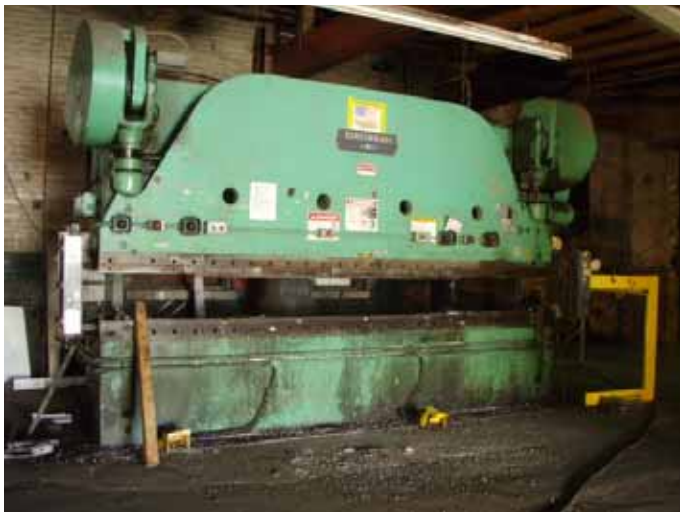
Press Brake, Cincinnati 9, s/n 37486, 12', 225 ton
